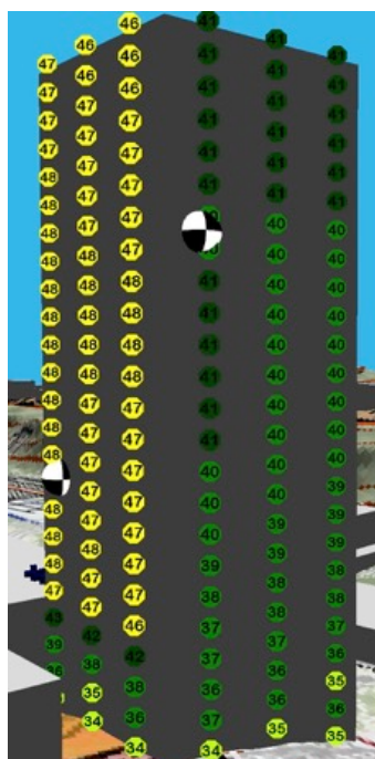
Figur 2: Beräknade nivåer dagtid efter att åtgärder utförts
